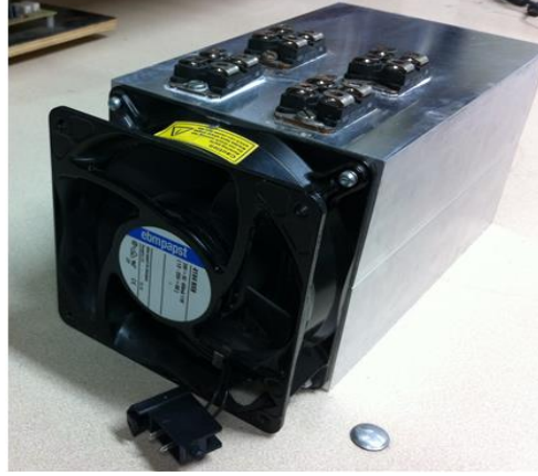
Fig. 3.6 Interruptores Mosfet unidos al disipador de calor.
