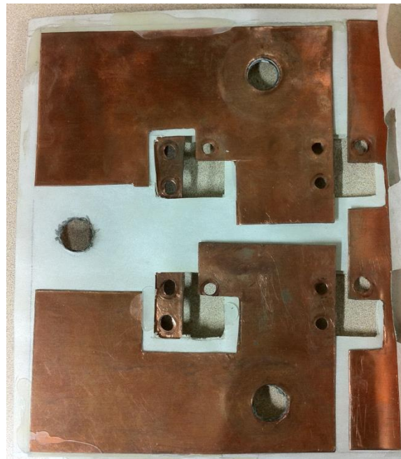
Fig. 3.10 Detalle de las placas y su conexión con los Mosfet.
