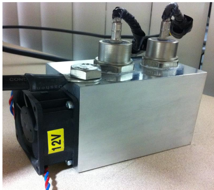
Figura 3.21 Diodos de protección para la fuente de alimentación programable.
