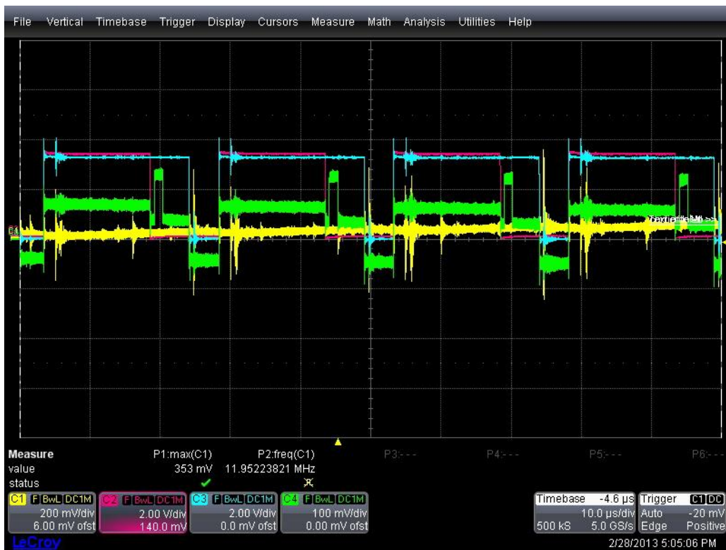
Fig. 5.3 PWM máximo limitado a d=0.8 (canal 3).
