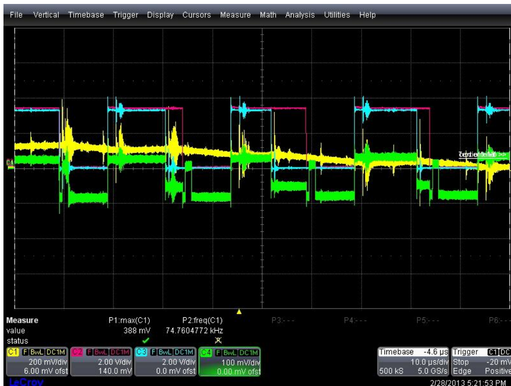
Fig. 5.4 PWM variable (canal 3) dependiente de la salida del comparador (canal 4).
