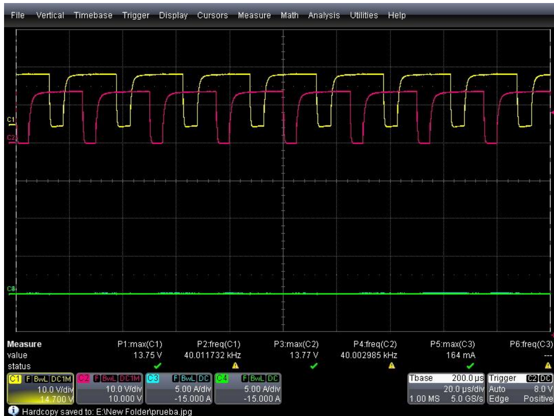
Fig. 5.2 Señales medidas entre las terminales de compuerta y fuente del Mosfet.
